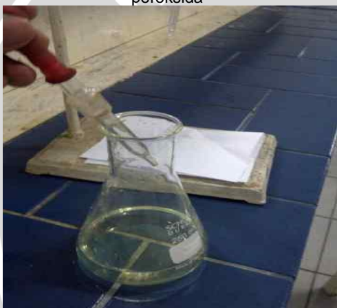
Penetesan dengan indikator pati untuk uji peroksida
