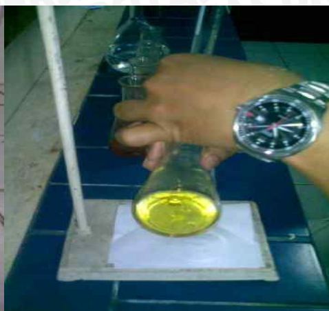
Awal titrasi peroksida untuk uji peroksida
