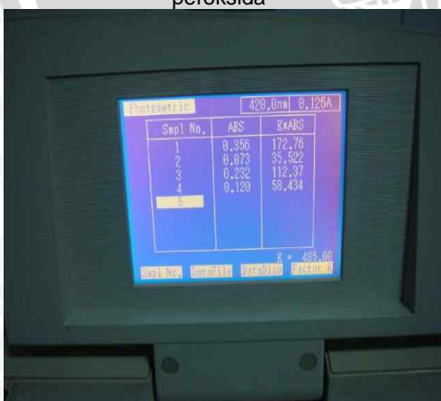
Sampel dimasukkan kemudian spektrofotometer membaca jumlah absorbansi untuk uji warna
