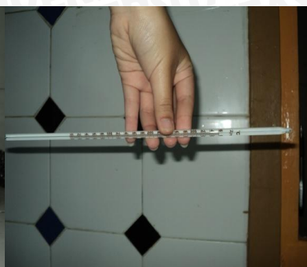
Termometer cairan untuk mengukur suhu minyak
