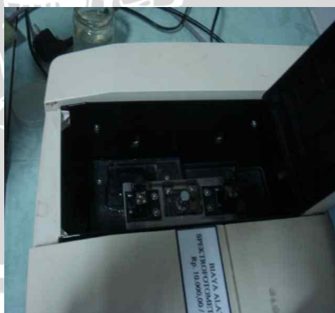
Spektrofotometer uv-vis untuk uji warna
