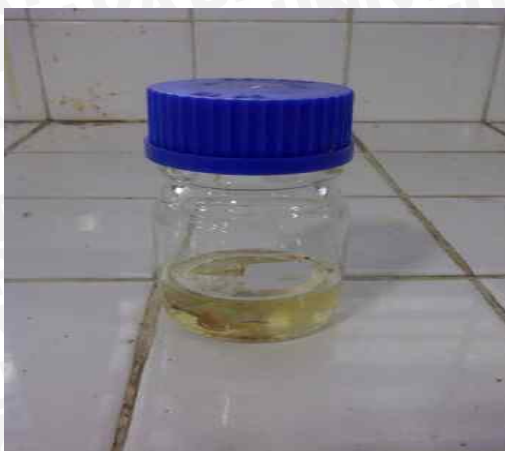
Pelarutan dengan kloroform asetat untuk uji peroksida
