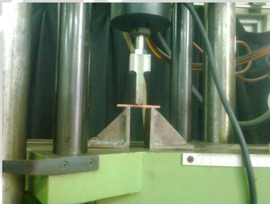
Sampel diletakkan pada mesin uji *bending*, sampel diletakkan tepat di tengah – tengah 2 tumpuan dan diberi beban di tengahnya.
