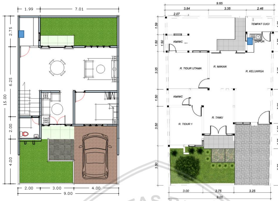
Gambar 4. 83 Peletakan portable grease trap pada dapur hunian 1 dan 3
