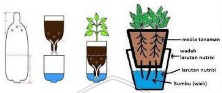
Gambar 4. Sketsa Media Tanam Hidroponik Sistem Sumbu
