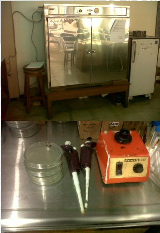
Gambar L.2.1 : Inkubator (suhu 37°C) dan Alat Uji Efektivitas Antibakteri
