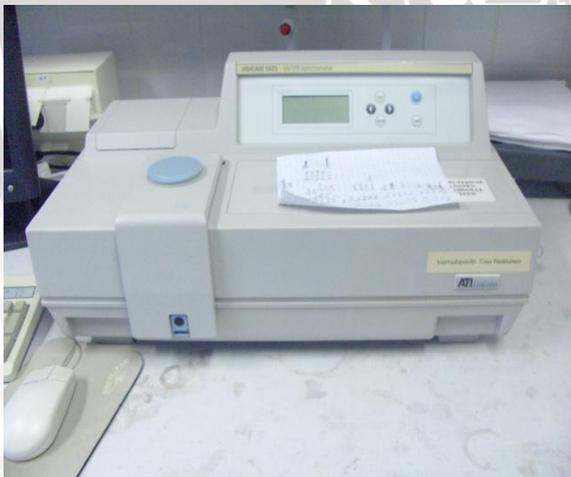
Gambar L.2.3 Spektrofotometri Untuk Menstandardisasi McFarland 0.5
