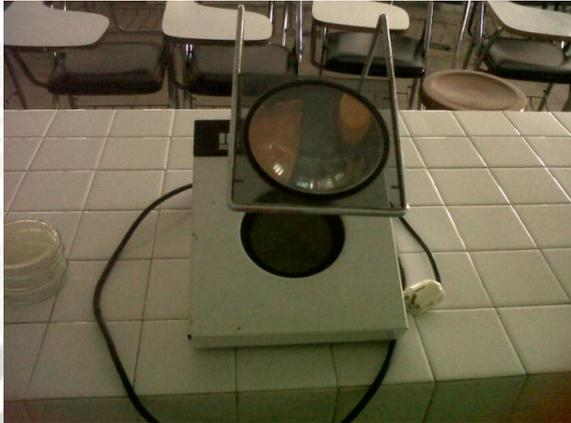
Gambar L.2.2 : Colony Counter Untuk Menghitung Jumlah Koloni dalam Media Agar
