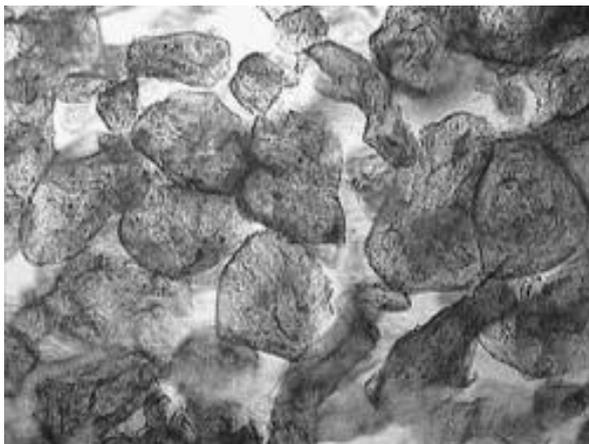
*Gambar 2.8* Celah yang timbul pada bagian permukaan spesimen dengan penambahan proses pembekuan di antara pengeringan
