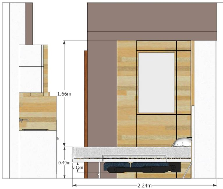
Gambar 4.53 Detail area istirahat/kasur saat digunakan
