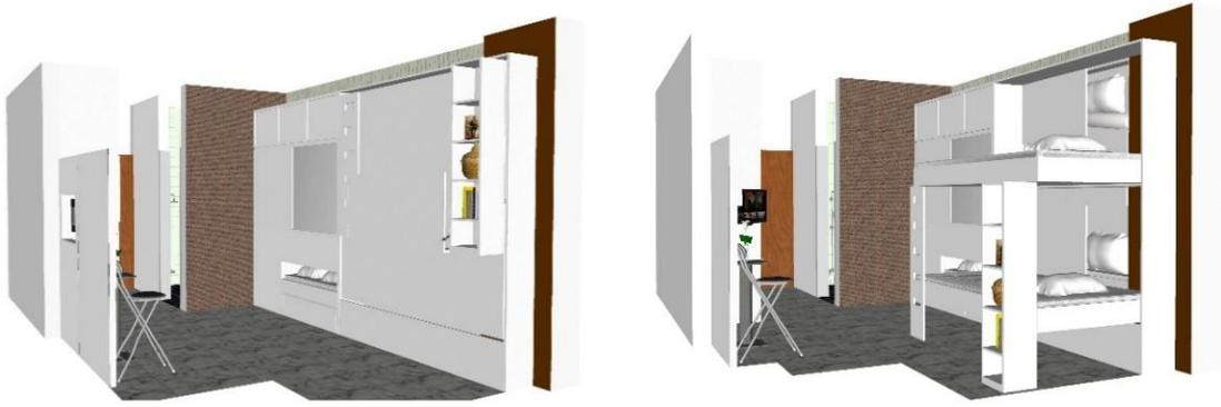
Gambar 4.37 Fold out level bed (kasur tingkat lipat)
