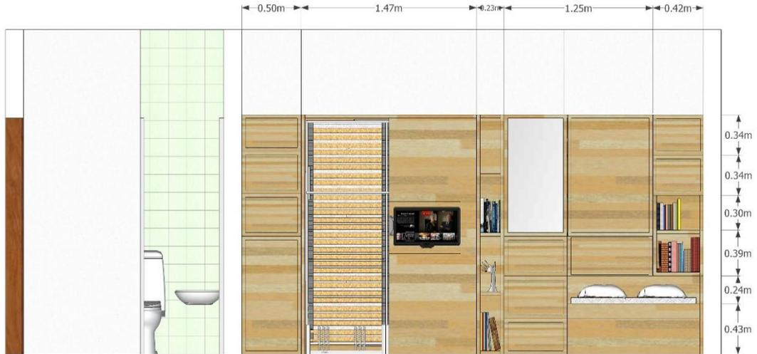
Gambar 4.28 Detail area istirahat/kasur, *seating area*, dan *clothes storage* saat tidak digunakan
