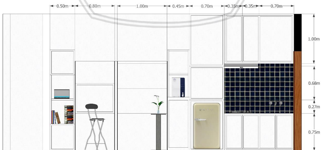
Gambar 4.30 Detail kitchen area dan workstation saat tidak digunakan
