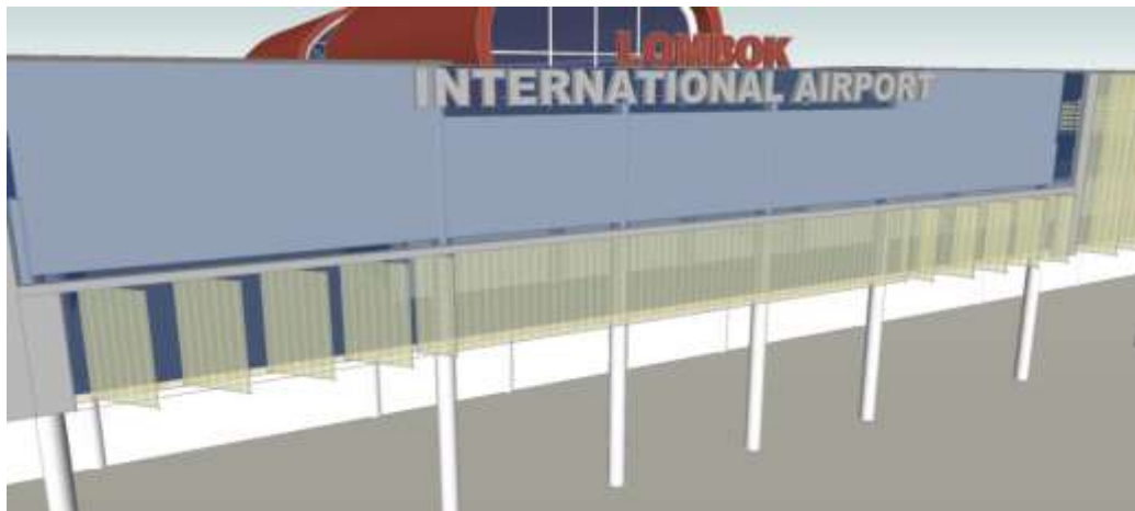
Gambar 4. 83 Detil sirip bukaan Timur Laut
