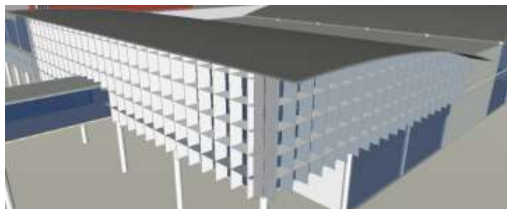
Gambar 4. 137 Detil egg create pada bukaan Timur Laut dan Barat Laut
