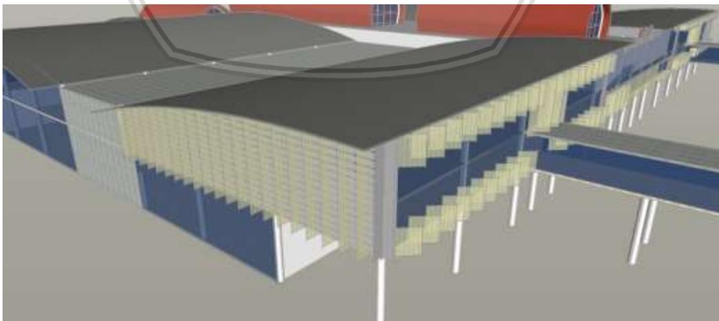
Gambar 4. 163 Detil sirip ruang tunggu internasional
