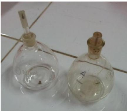
Gambar 3.3 Peralatan untuk analisis berat jenis tanah : labu ukur.
