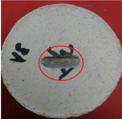
Gambar 4.2 Foto jejak keusakan lelah yang terjadi di spesimen uji
