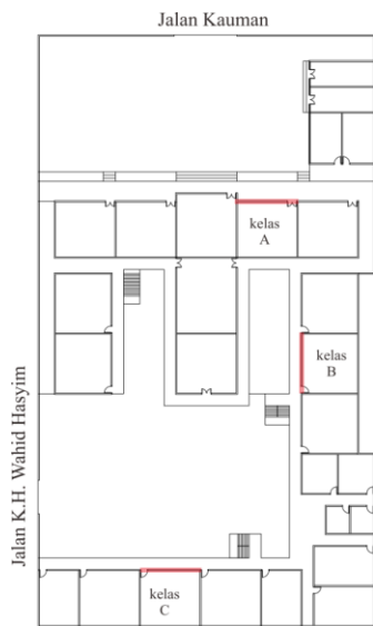
Gambar 4.60 Letak dinding perhitungan SRI pada ruang kelas di lantai 1
