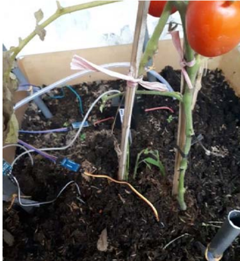
Gambar 4.6 Posisi Sensor dan Pompa Air
