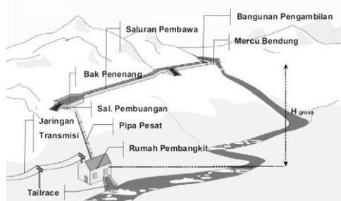
Gambar 2.4 Skema Pembangkit Listrik Tenaga Mini Hidro
