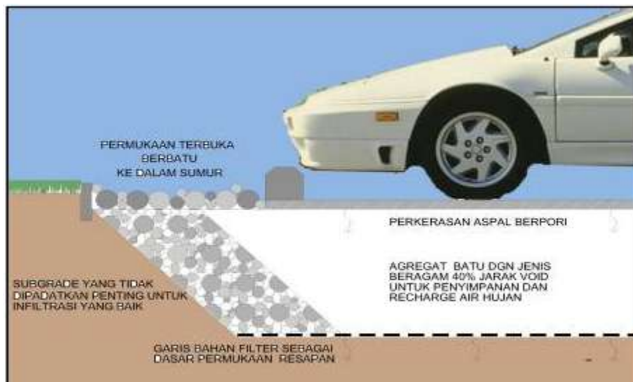
Gambar 3.9. Potongan Melintang Perkerasan Aspal Berpori
