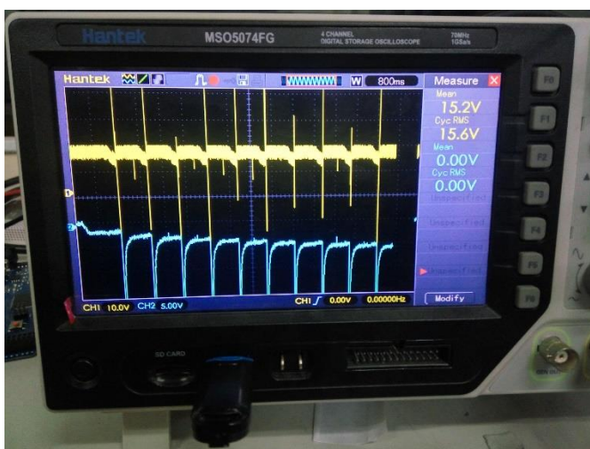
Gambar L3.1 Grafik Pengujian V_s > V_c dengan V_s = 15\text{ V} , set point arus 1 A
