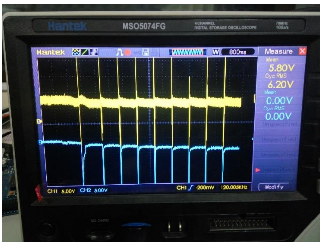
Gambar L3.1 Grafik Pengujian V_s > V_c dengan V_s = 5\text{ V} , set point arus 2 A
