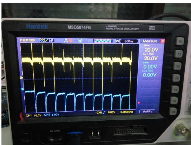
Gambar L3.1 Grafik Pengujian V_s > V_c dengan V_s = 20\text{ V} , set point arus 1 A
