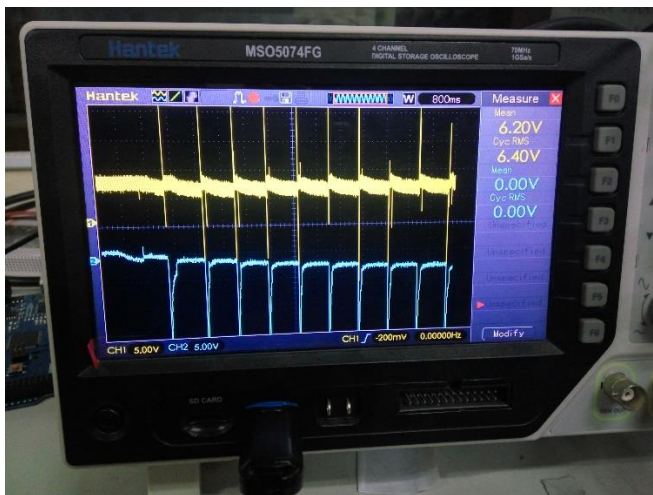
Gambar L3.1 Grafik Pengujian V_s > V_c dengan V_s = 5\text{ V} , set point arus 2 A
