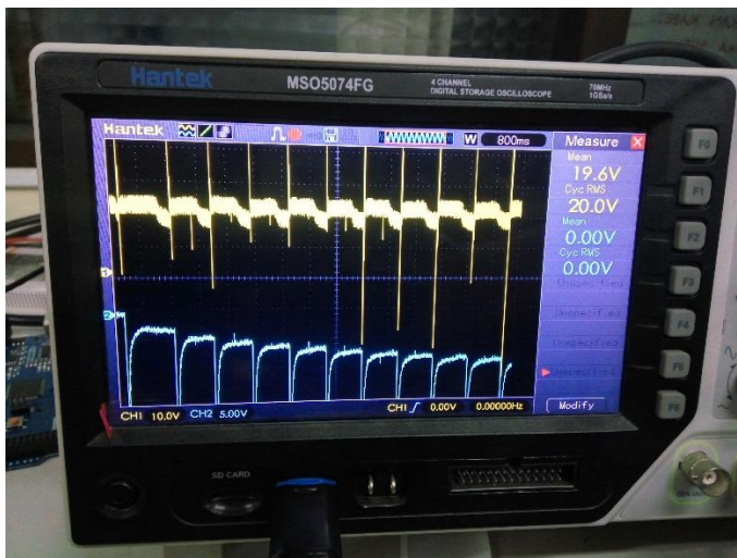
Gambar L3.1 Grafik Pengujian V_s > V_c dengan V_s = 20 V, set point arus 3 A
