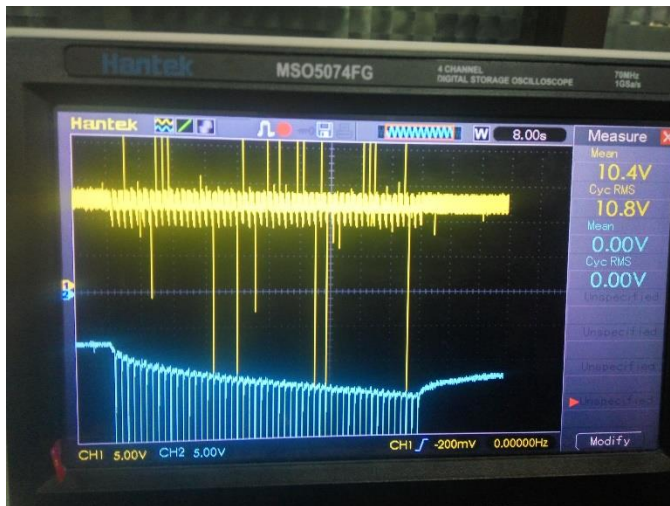
Gambar L3.3 Grafik pengujian limit tegangan kapasitor pada 17 V, dengan V_s = 10 V, set point arus 1 A
