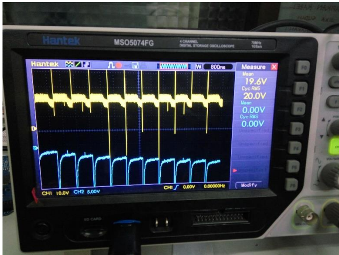
Gambar L3.1 Grafik Pengujian V_s > V_c dengan V_s = 20 V, set point arus 2 A
