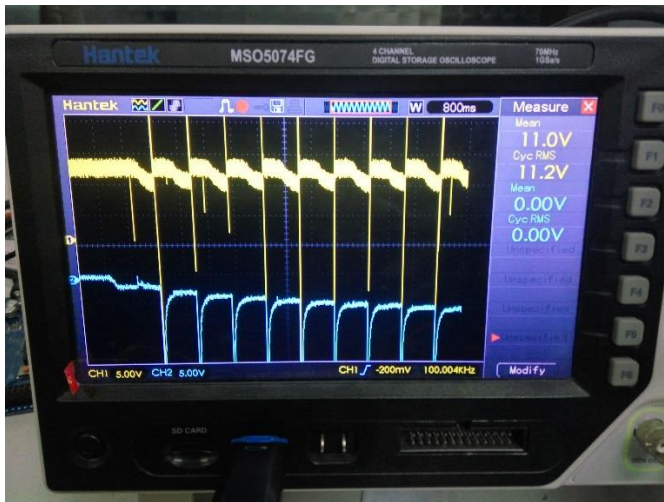
Gambar L3.1 Grafik Pengujian V_s > V_c dengan V_s = 10\text{ V} , set point arus 2 A
