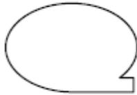
Simbol magnetic tape, menyatakan input berasal dari pita magnetis atau output disimpan ke pita magnetis
