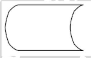
Simbol disk storage, menyatakan input berasal dari dari disk atau output disimpan ke disk
