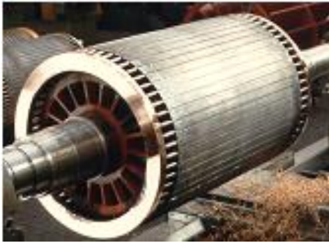
Gambar 2. 5 Konstruksi rotor sangkar tupai Sumber : Henneberger (2002,p.125)
