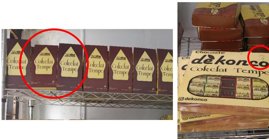
Gambar 5. Cacat Warna Kemasan Berbeda
