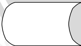
*On-line storage*, simbol ini menggambarkan arsip komputer yang berbentuk *on-line* (didalam memory komputer).
