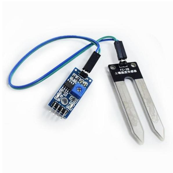
**Gambar 2.4** Sensor kelembapan tanah
