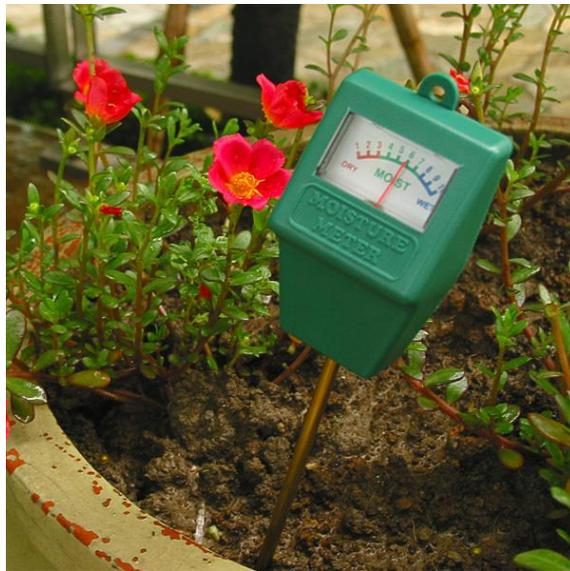
**Gambar 2.1** Alat pengukur kelembapan tanah
