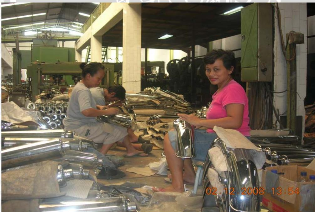
**Gambar 8: Proses kerja di bagian poles dan pengepakan**
