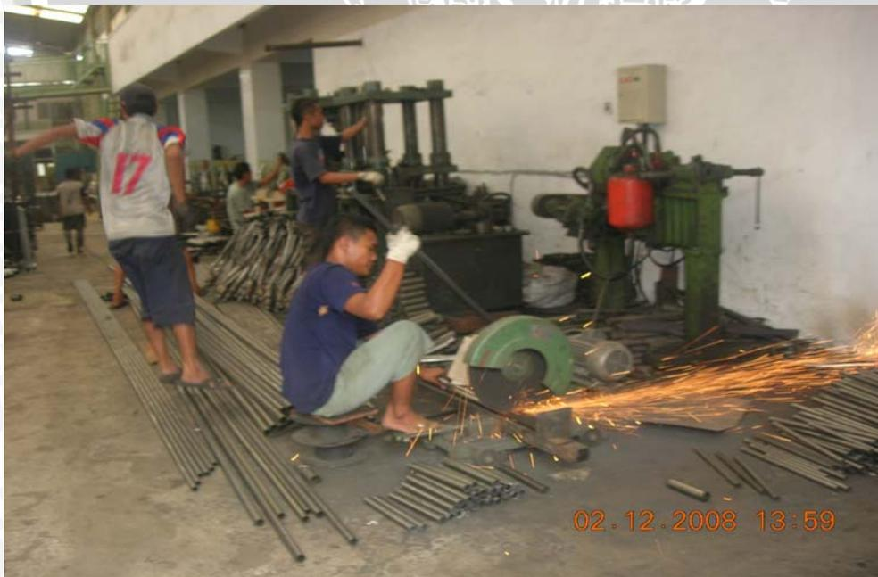
**Gambar 4: Proses kerja di bagian gunting (sedang memotong pipa)**
