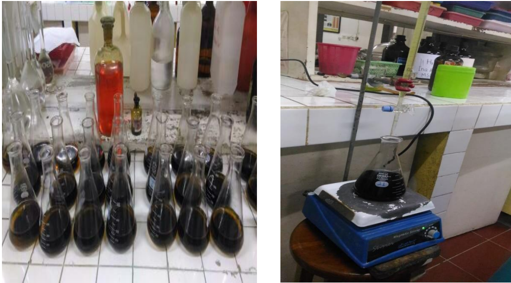
Gambar 5. Analisis %C-organik tanah
