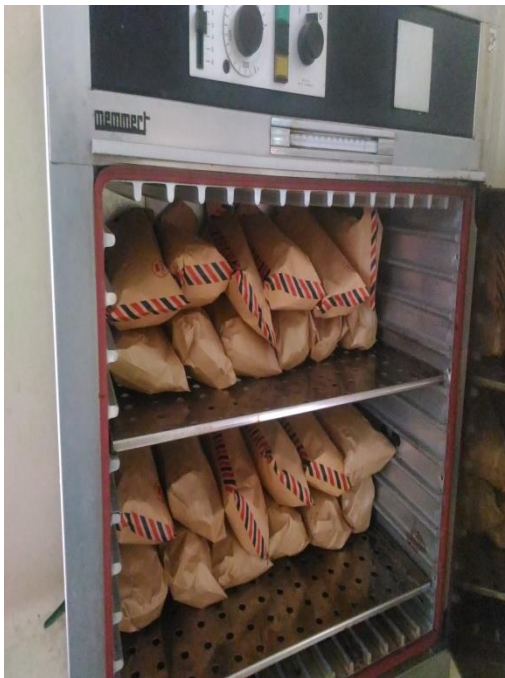
Gambar 4. Pengovenan sampel tanah dan seresh
