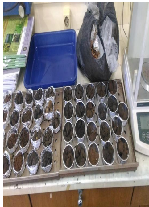
Gambar 4. Pengovenan sampel tanah dan seresh
