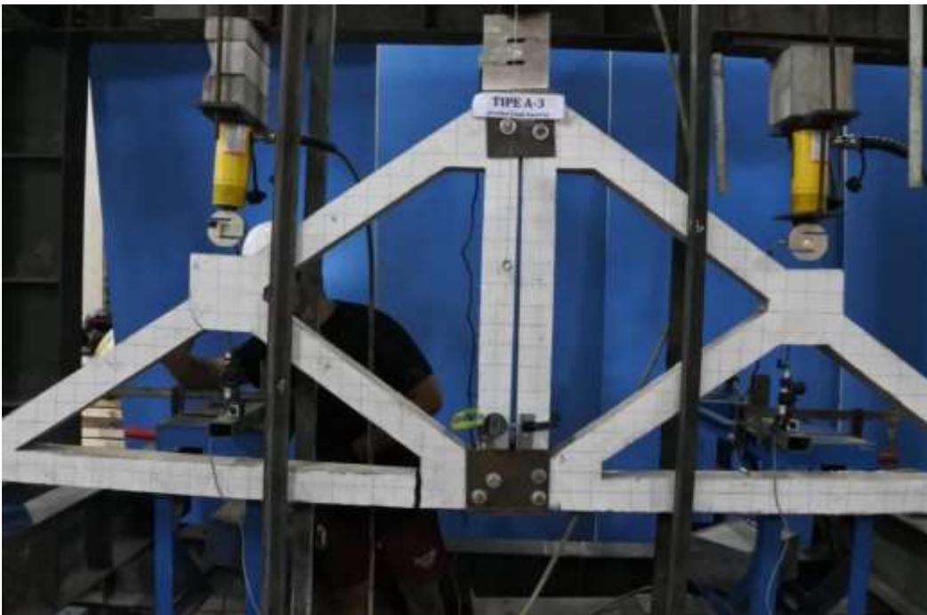
Gambar 4.3 Foto benda uji a-3 vertikal tidak simetris setelah *collapse*
