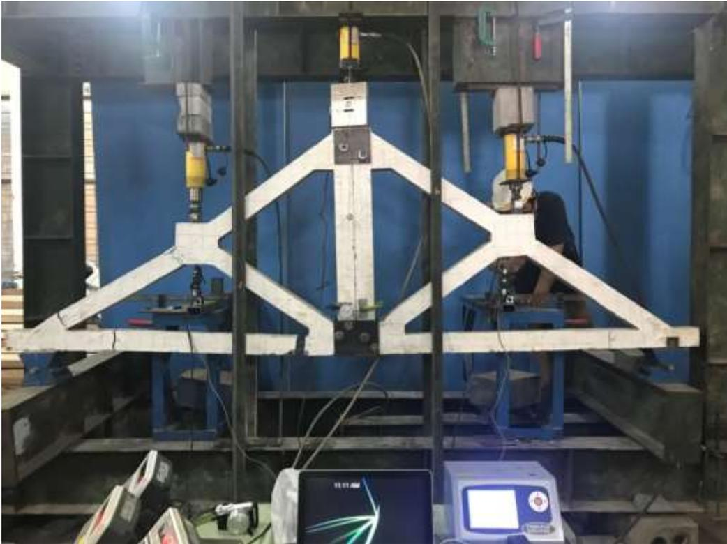
Gambar 4.2 Foto benda uji a-5 vertikal simetris setelah *collapse*
