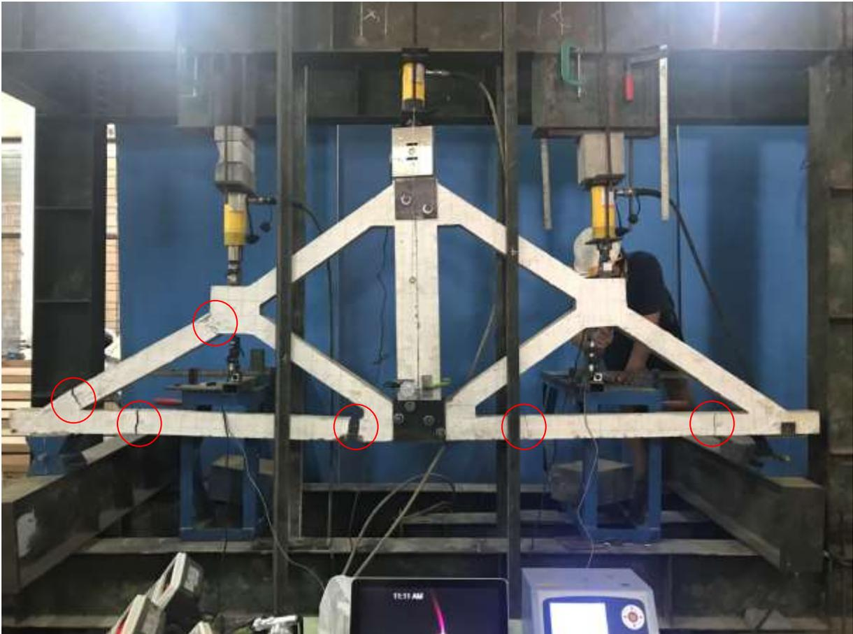
Gambar 4.4 Foto titik runtuh pada benda uji a-5 vertikal simetris setelah *collapse*
