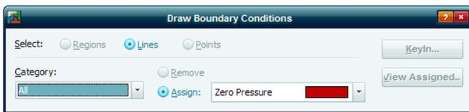
Gambar 2.45. Setting Draw Boundary Conditions pada SEEP/W
