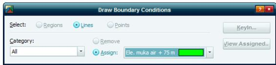
Gambar 2.47. Setting Elevasi Muka Air pada *Keyin Boundary Conditions*
