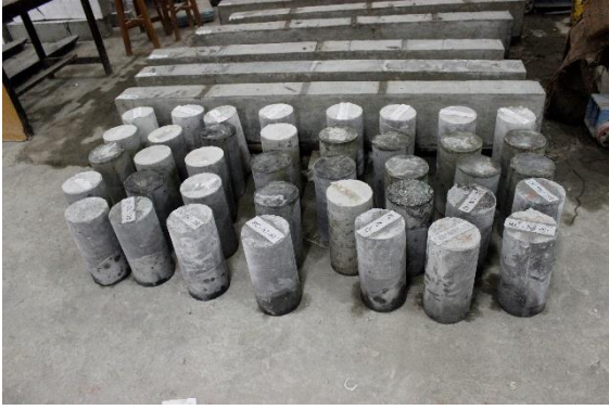
Gambar L 8.15 Benda uji silinder dan balok beton bertulang
