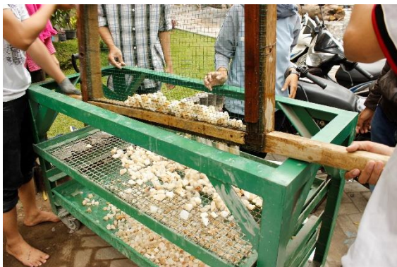
Gambar L 8.3 Pengayakan Agregat Onyx
