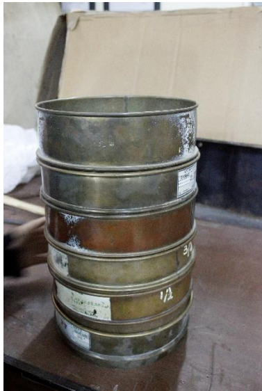
Gambar L 8.2 Pemeriksaan Gradasi Agregat Kasar dan Halus
