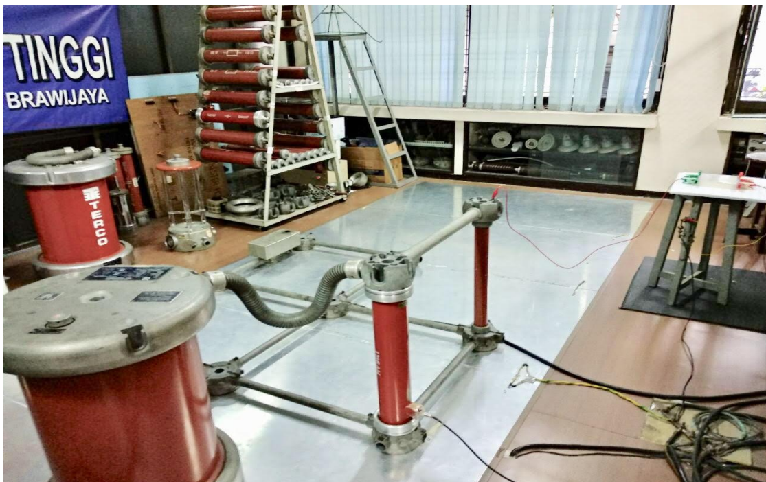
Gambar rangkaian AC pengujian nilai arus bocor pada permukaan islator kaca di Laboratorium Tegangan Tinggi JTE-UB
