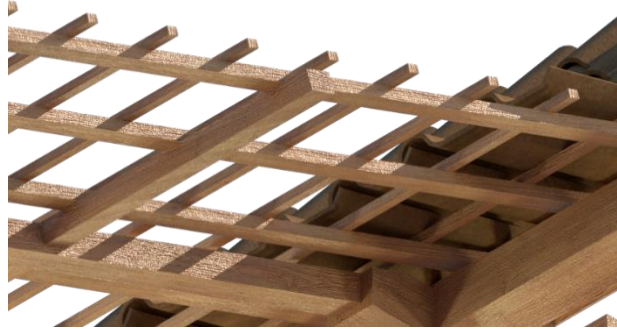
Gambar 4.31 Konstruksi usuk, reng, dan genteng
