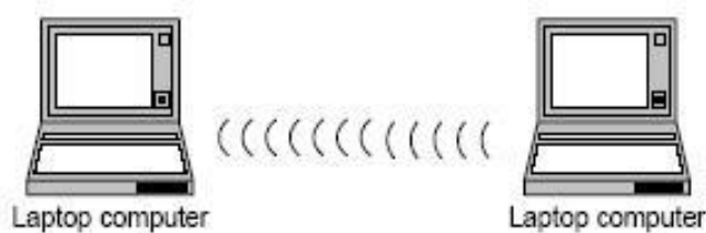
Gambar 2.2 Prinsip kerja topologi ad hoc
