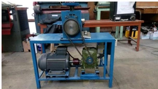
Gambar 3.1 Mesin *Roll Bonding*
