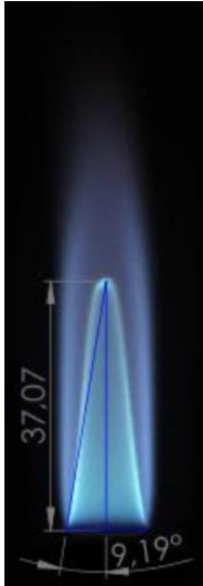
Gambar 4.3 Pengolahan data karakteristik nyala api bunsen burner pada ketinggian ring pemanas 98 mm untuk equivalence ratio 1,40
