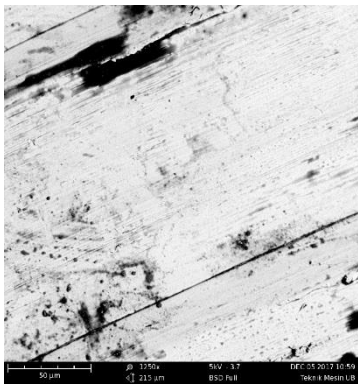
Gambar 4.1 Hasil foto uji mikrostruktur sebelum electropolishing
