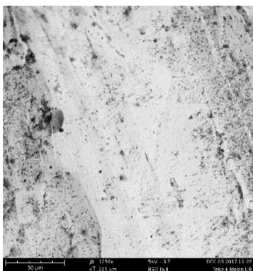
Gambar 4.9 Hasil foto SEM dengan variasi tegangan 4 volt, suhu 50°C dan perbesaran 1250x
