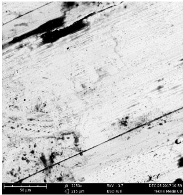
Gambar 4.7 Hasil foto SEM sebelum di electropolishing dengan perbesaran 1250x
