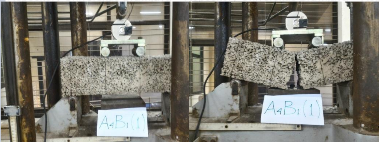
Gambar 4.6 Balok beton porous sebelum dan sesudah diuji
