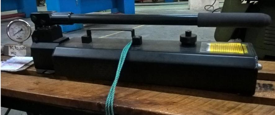
Gambar 3.2 Pompa Hidrolik
