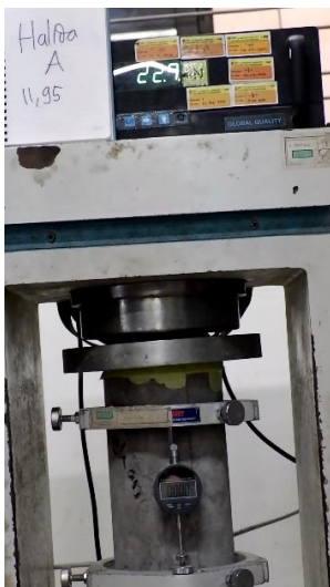
Gambar 2.2 Uji kuat tekan beton
