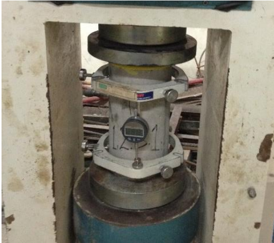
Gambar 2.6 Uji Modulus Elastisitas menggunakan extensometer
