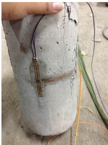
Gambar 4.47 Uji modulus elastisitas dengan menggunakan strain gauge
