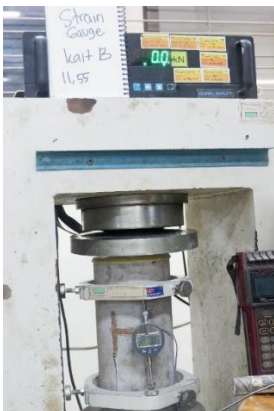
Gambar 4.28 Proses Pengujian Kuat Tekan Silinder Beton
