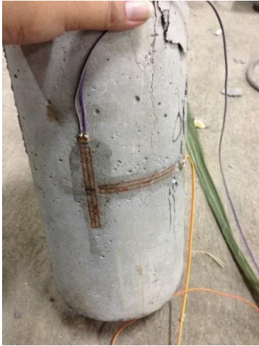
Gambar 4.47 Uji modulus elastisitas dengan menggunakan strain gauge
