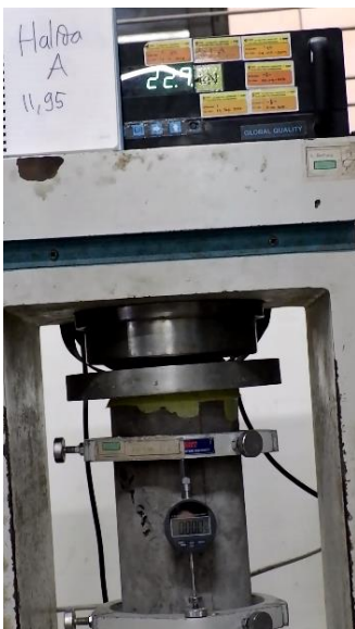
Gambar 4.3 Proses Pengujian Kuat Tekan Silinder Beton
