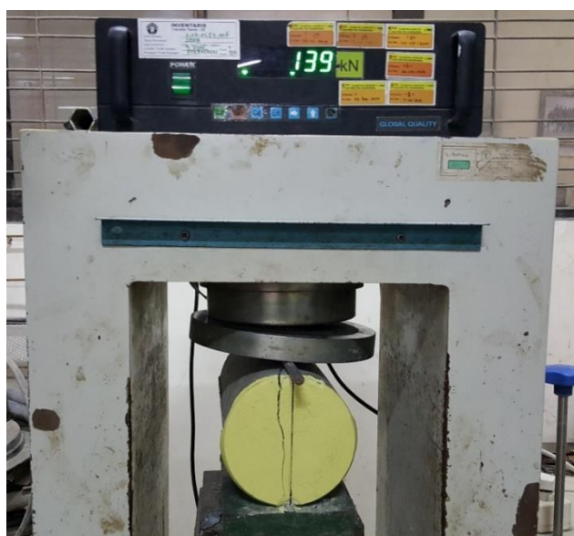
Gambar 4.24 Proses Pengujian Kuat Tarik Belah Silinder Beton
