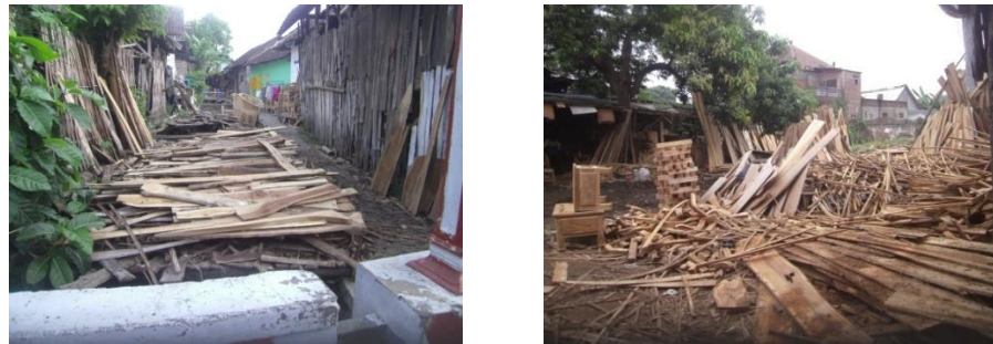
Gambar 4. 8 Proses Pengeringan Balok-balok Kayu dengan Menggunakan Sinar Matahari Langsung
