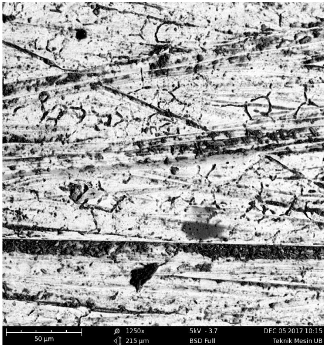
Gambar 4.8 Foto uji SEM variasi tegangan 6 volt dengan waktu 3 menit
