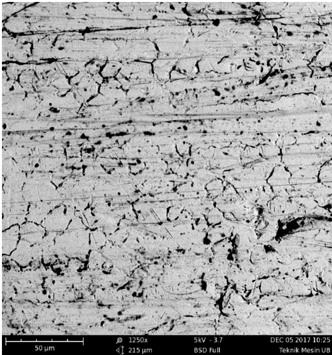
Gambar 4.11 Foto uji SEM variasi tegangan 6 volt dengan waktu 4 menit
