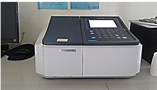
*Gambar 2. 12* Spektrofotometer *UV-1800*
