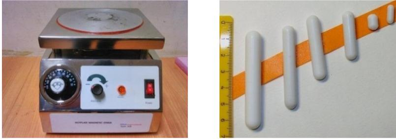
Gambar 2. 10 *Magnetic stirrer* (Kiri) dan *magnetic stir bar* (Kanan)
