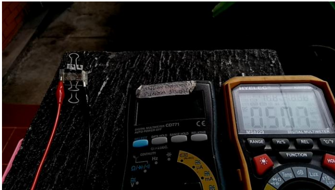
Proses Pengujian Tegangan dan Arus dengan Menggunakan Lampu LED Cool Daylight 7
