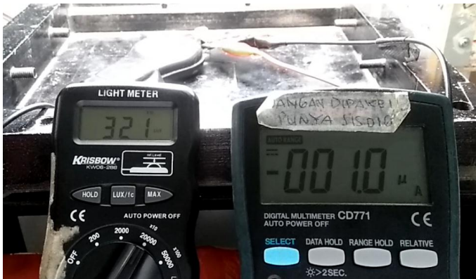
Proses Pengujian Tegangan dan Arus dengan Menggunakan Lampu LED Cool Daylight 7
