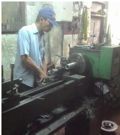
Gambar 4.8 Proses pembubutan Sumber: PT. Semeru Jaya (2015)
