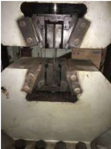
Gambar 3.9. Pengujian kuat tarik tulangan baja.
