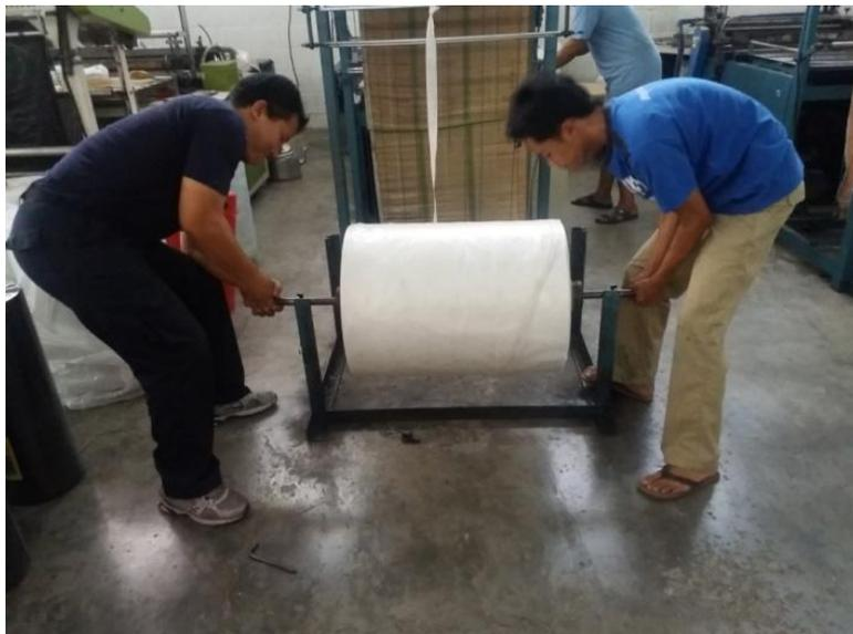
Gambar 4.6 Pengangkatan gulungan *inner* karung ke mesin pemotong
