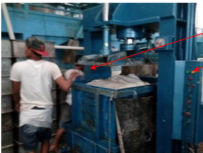
Gambar 4.13 Proses press dengan mesin hidrolik
