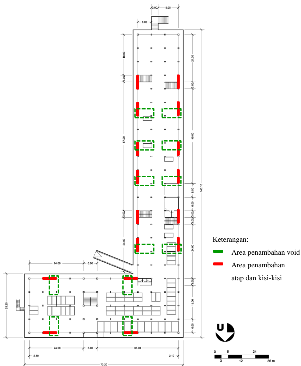
Gambar 4.84 Rekomendasi penambahan void, atap dan kisi-kisi
