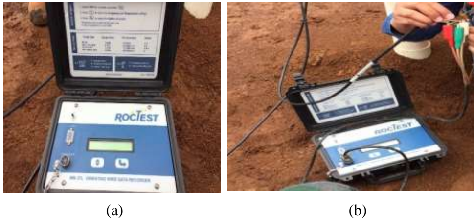
Gambar 2.18 (a) Vibrating Wire Piezometer recorder (b) Proses penggunaan Vibrating wire piezometer
