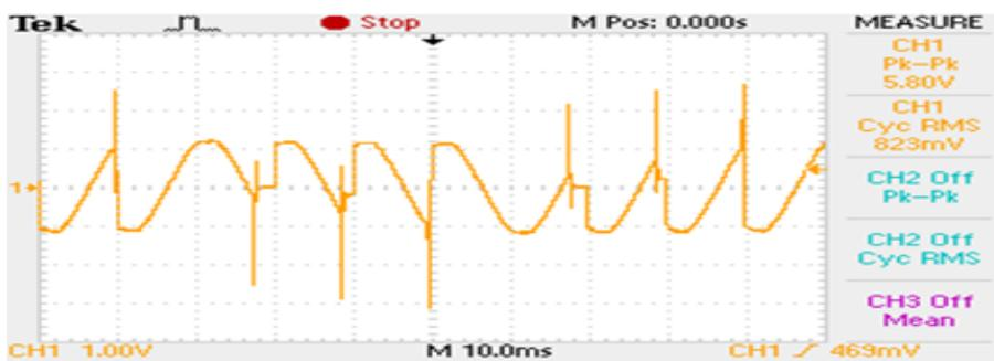
Gambar 5.13 Tegangan keluaran *cycloconverter* saat berbeban motor induksi
