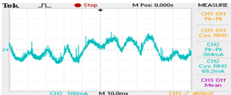
Gambar 5.14 Arus keluaran *cycloconverter* saat berbeban motor induksi
