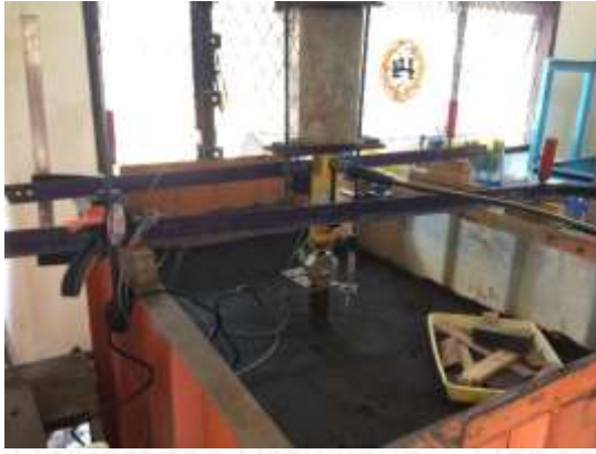
Gambar 3.9 LVDT yang telah terpasang.
