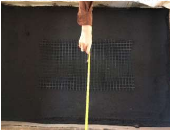
Gambar 3.7 Perletakan geogrid pada sampel uji.
