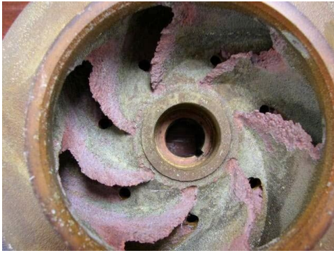
Gambar 2.6 Korosi erosi pada sebuah blade Sumber: https://tsffaunsoed2009.wordpress.com
